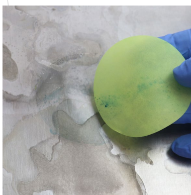
Freies Eisen auf einer Platte aus rostfreiem Stahl
