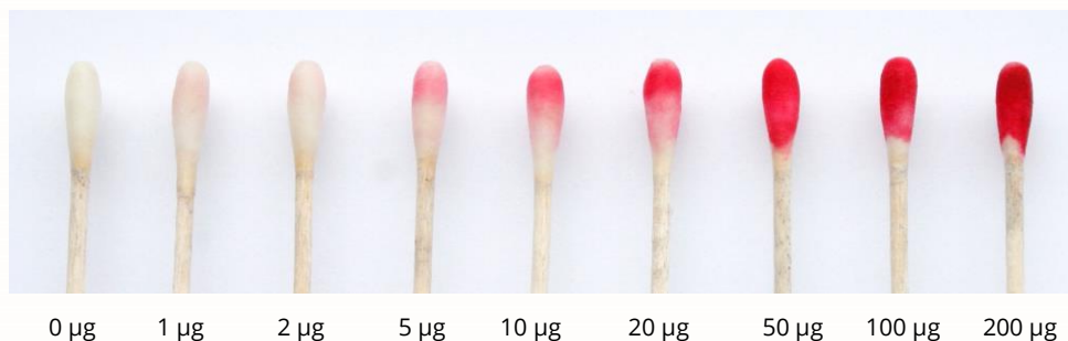
Abbildung 1. Ergebnis des Bleitests bei unterschiedlichen Bleimengen.
